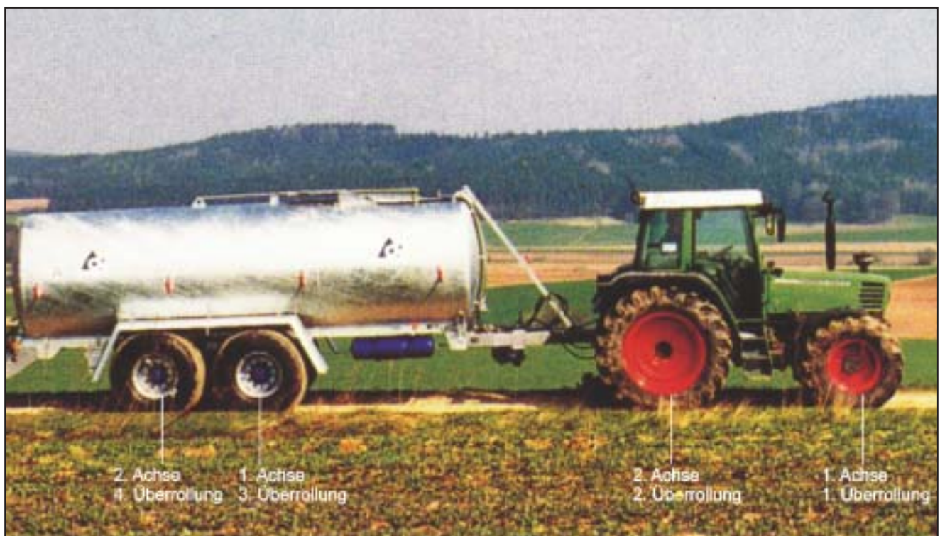
Abb. 3.2: Achsen und Überrollungen eines Traktors mit Gülleanhänger
