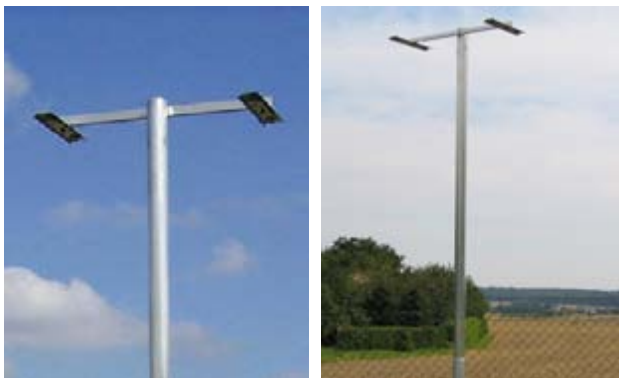
Abb. 4-14: Passivsammler zur Bestimmung der Ammoniak-Konzentration in der Außenluft
