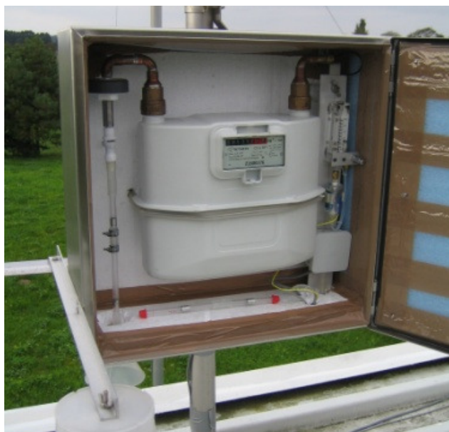
Abb. 4-15: Denudersystem zur aktiven Probenahme gasförmiger Verbindungen in der Außenluft (hier für Ammoniak)
